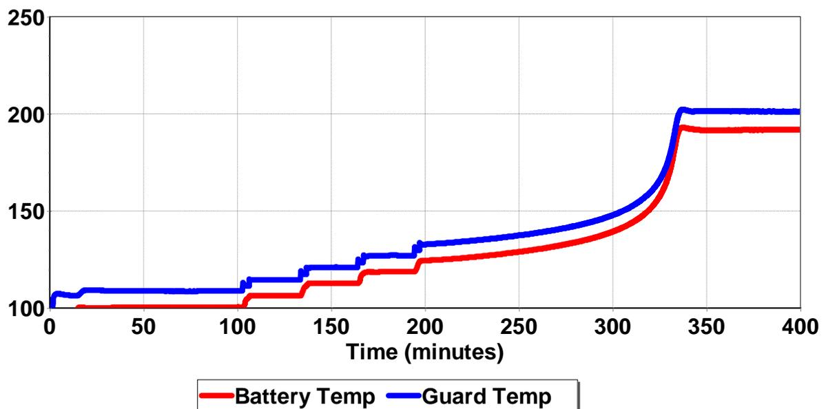
FIGURE 1. DATA FROM TESTING UNDAMAGED LI-ION BATTERY PACK
