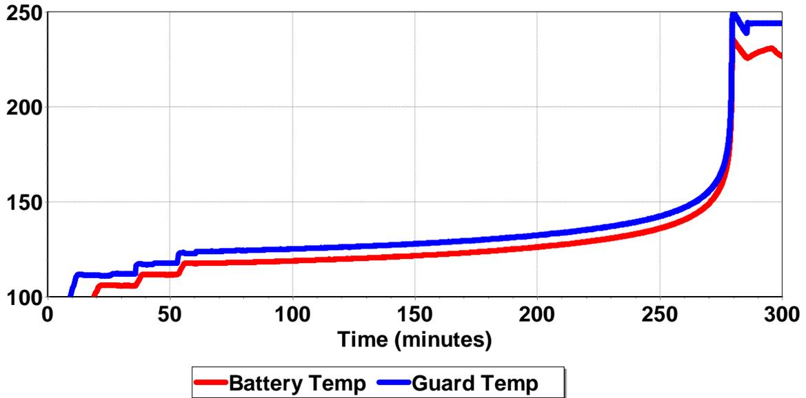
FIGURE 2. DATA FROM TESTING DAMAGED LI-ION BATTERY PACK
