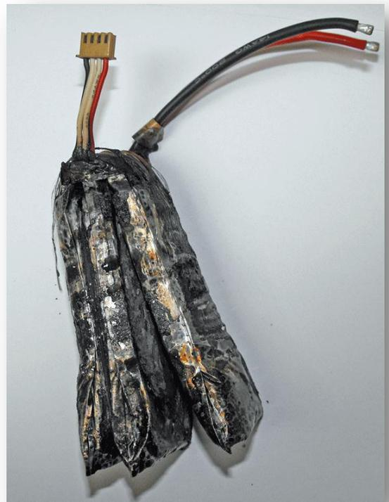
FIGURE 3. DAMAGED BATTERY PACK AFTER THE TEST
